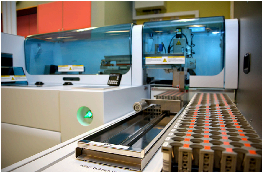
Robotten som modtager blodprøverne fra rørsystemet og sender dem videre til analyse i laboratoriet. Foto: Thomas Wittrup
